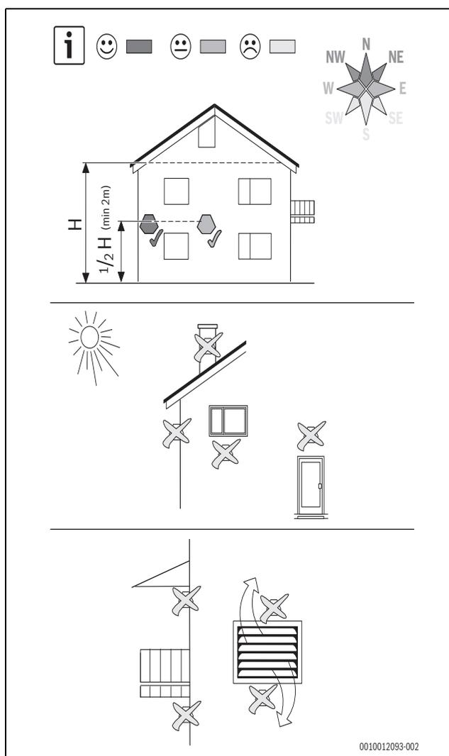
Fig. 27 Position de la sonde de température extérieure
