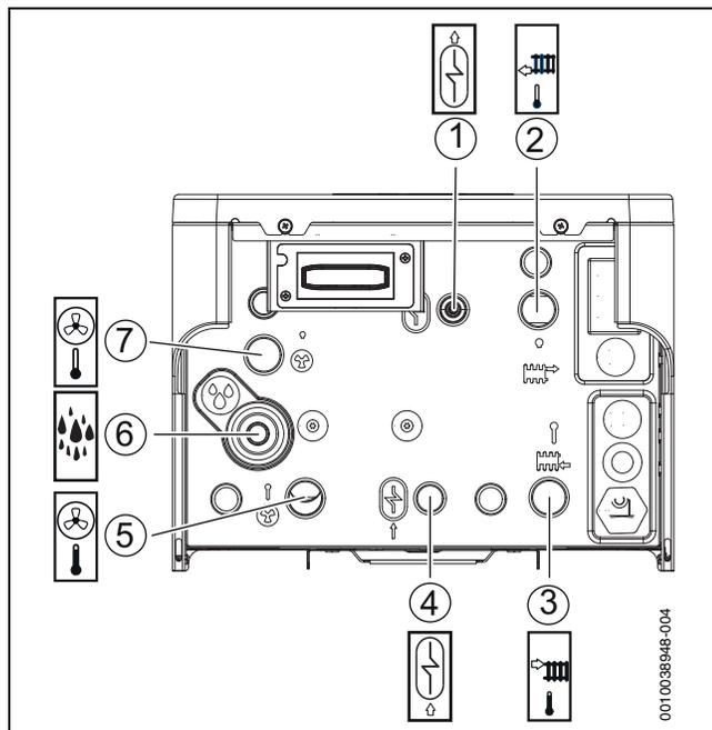
Fig. 6 Raccordements de conduites
