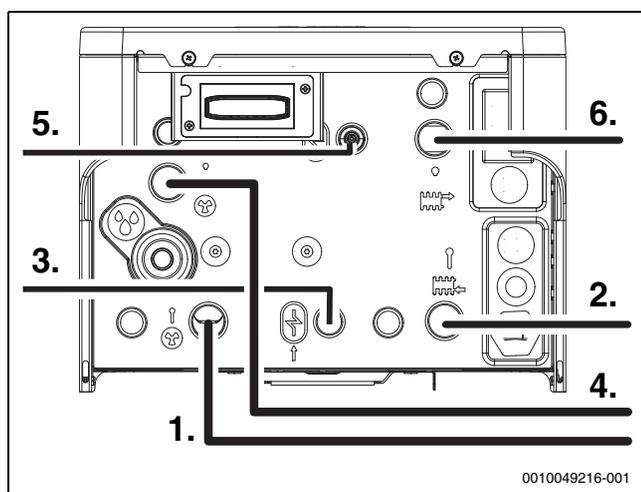
Fig. 17 Raccords de tubes
