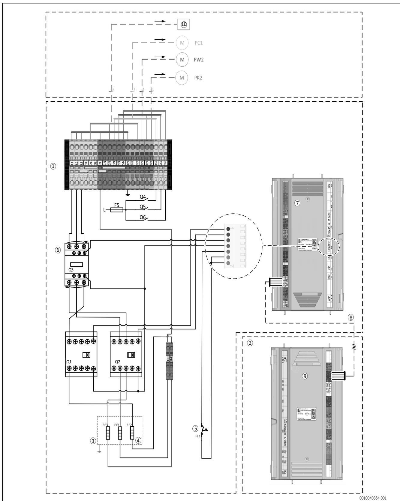
Fig. 46 Alimentation électrique de l'unité intérieure, standard
