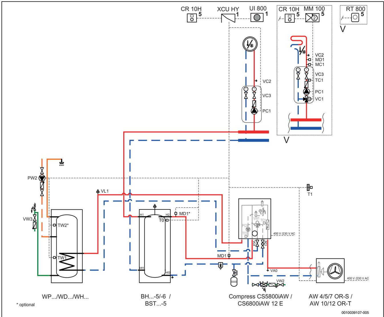
Fig. 42 Pompe à chaleur, unité intérieure, ballon tampon et chauffe-eau
