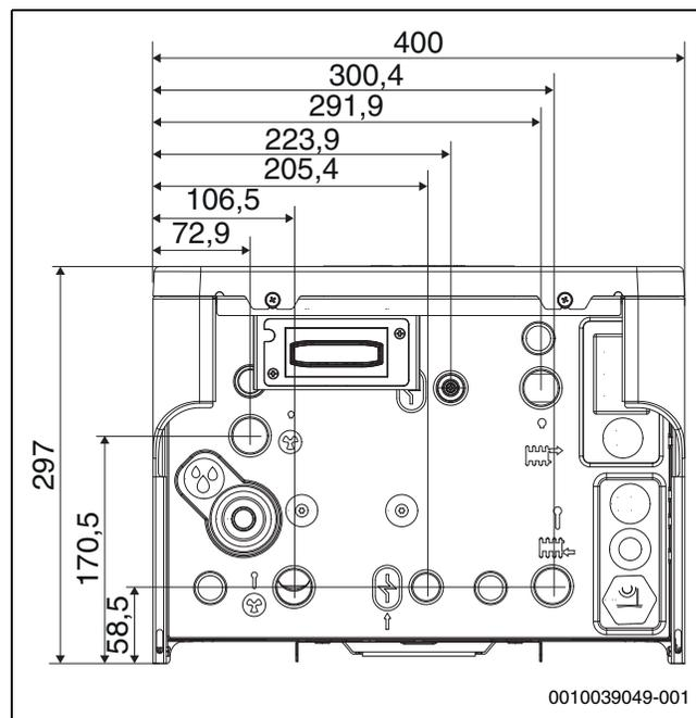
Fig. 3 Dimensions, raccordements, vue de dessous (mm)
