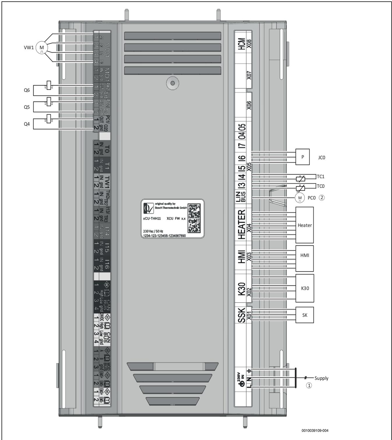
Fig. 45 Schéma de câblage XCU-THH (XCU HY)
