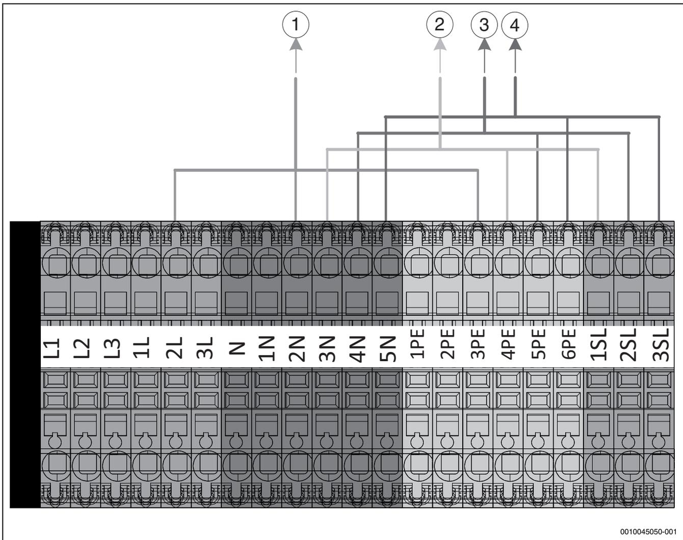
Fig. 36 Raccordements électriques des accessoires
