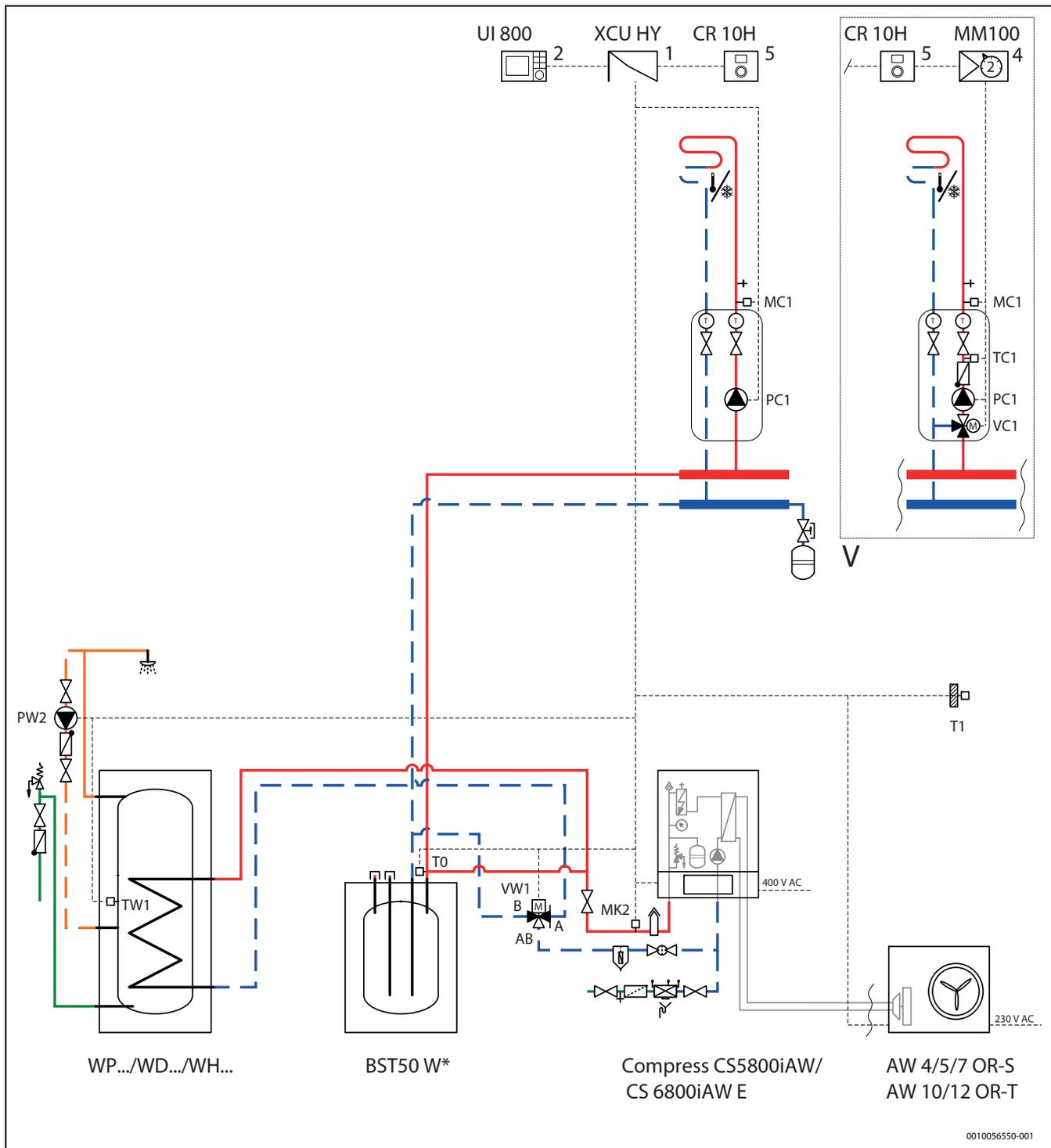
Fig. 41 Pompe à chaleur avec unité intérieure, ballon tampon et préparateur d'eau chaude sanitaire
