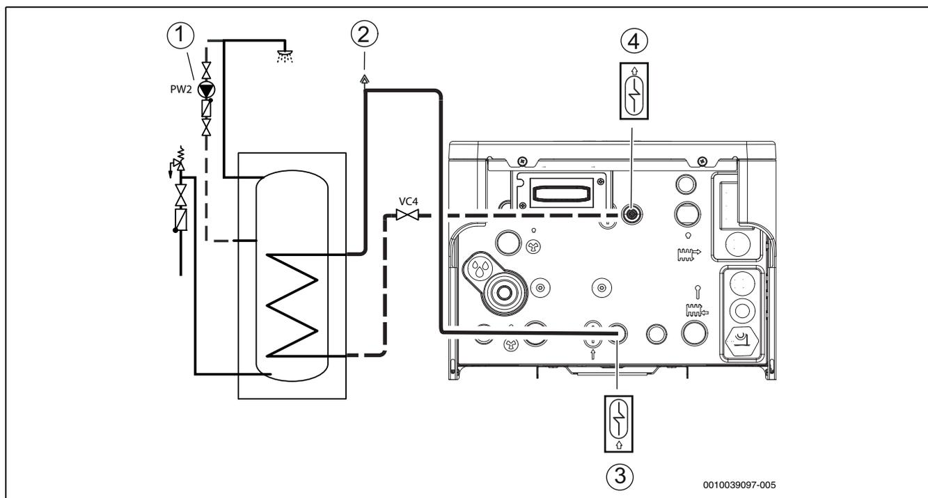
Fig. 21 Raccordements de l'unité intérieure à l'eau du réseau potable
