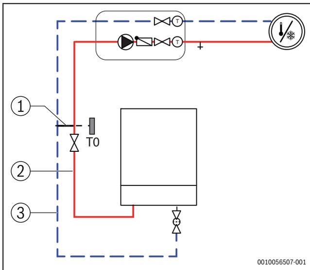
Fig. 11 Circuit de chauffage avec by-pass
