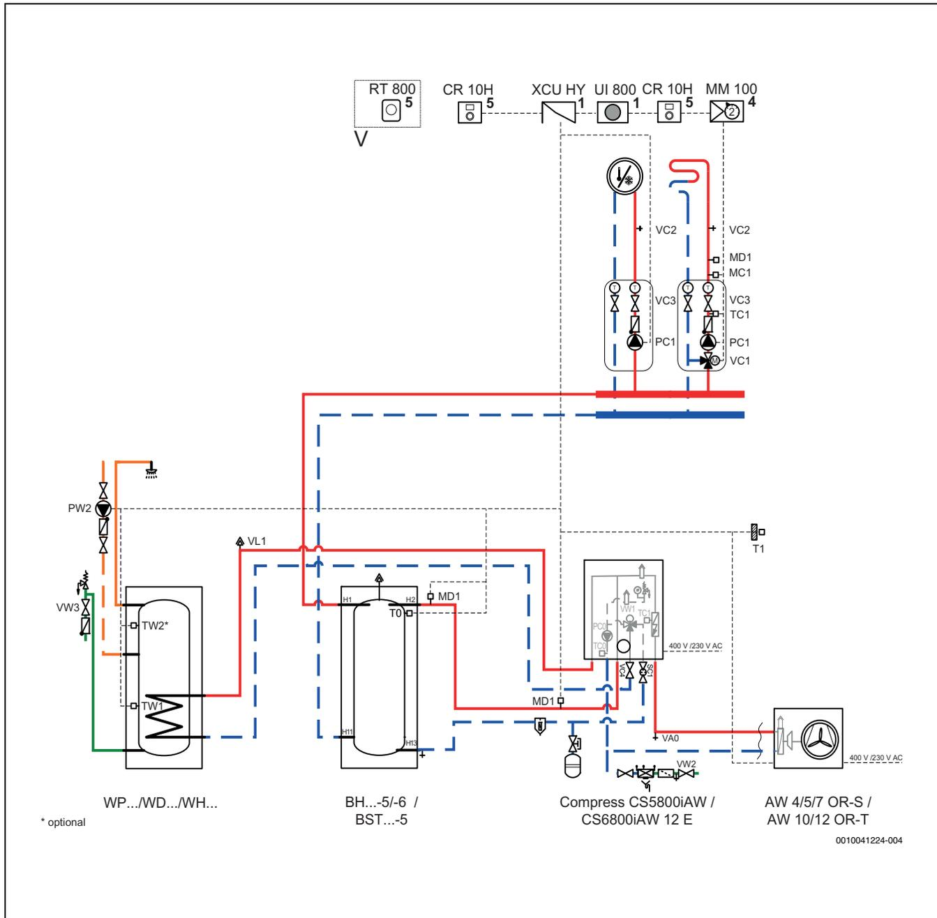
Fig. 43 Pompe à chaleur, deux circuits de chauffage, unité intérieure, ballon tampon et ballon d'ECS
