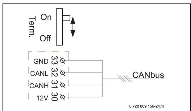
Fig. 10 Terminaison CAN-BUS
