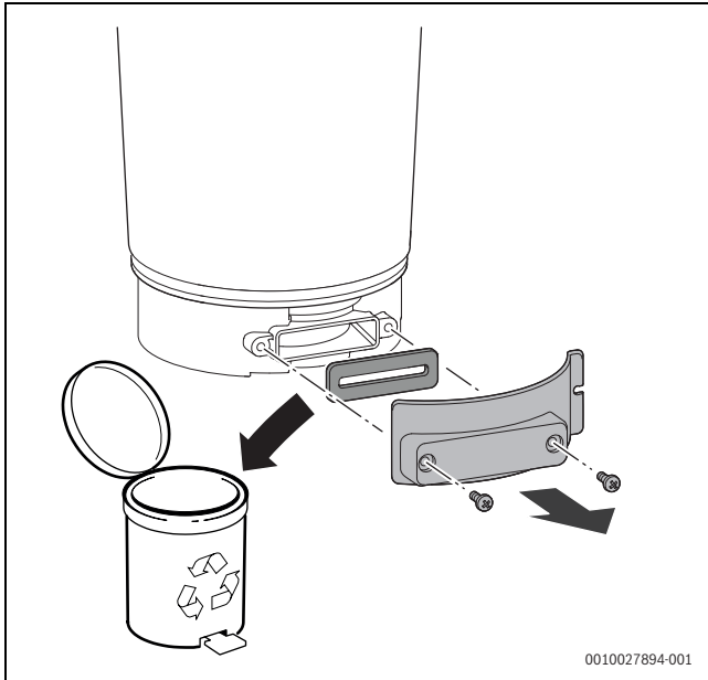
Afb. 144 Open de inspectieopening
