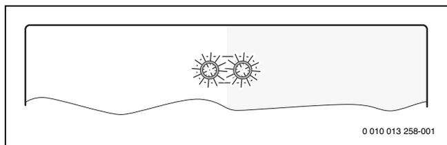
Wenn am Modul eine Störung auftritt, wird der Mischer im angeschlossenen gemischten Heizkreis auf eine vom Modul festgelegte Position gestellt. Dadurch ist es möglich, die Anlage mit reduzierter Wärmeleistung weiter zu betreiben.
