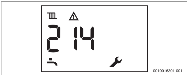
Afb. 4 Voorbeeld van een storingscode
