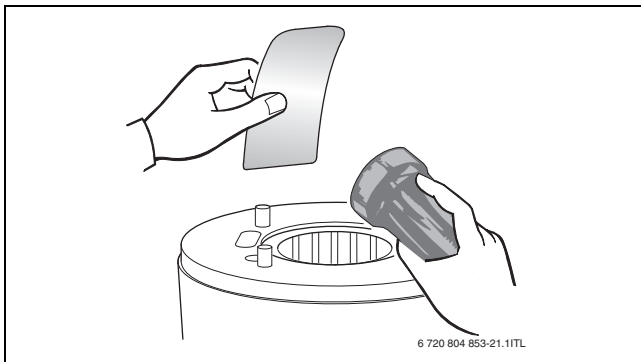
Afb. 58 Controleer het verwarmingslichaam op restanten
