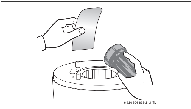
Afb. 57 Controleer het verwarmingslichaam op restanten
