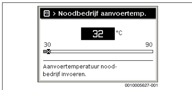
Afb. 81 Aanvoertemperatuur voor het noodbedrijf
