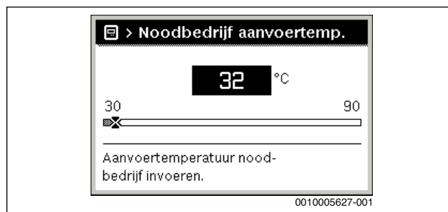
Afb. 13 Aanvoertemperatuur voor het noodbedrijf
