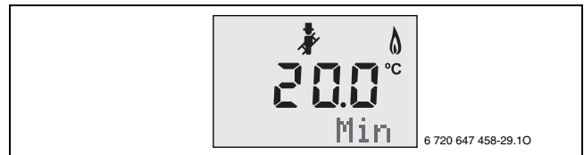
Afb. 66 Min (=minimaal nominaal verwarmingsvermogen) knippert
